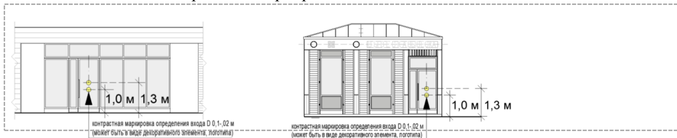
Рис. «Внешний вид контрастной маркировки входа»
