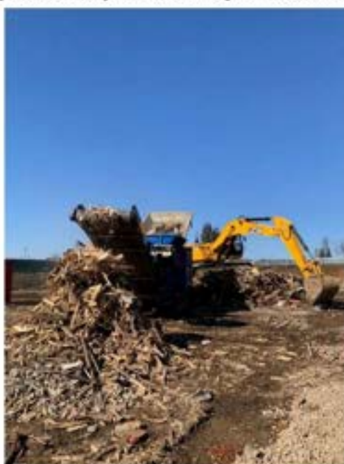
Рис. 7 – технологическая операция дробления крупных древесных отходов
