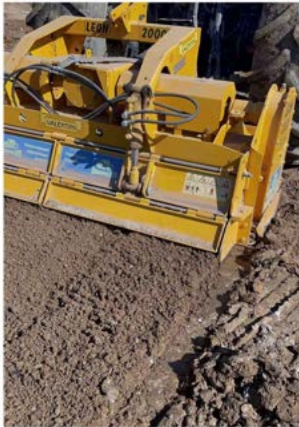
Рис. 14 – процесс изготовления рекультиванта минерального первым способом
