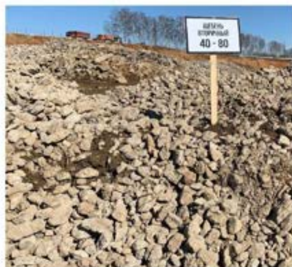
Рис. 8 – щебень вторичный с размерами фракций 20-40 и 40-80 мм
