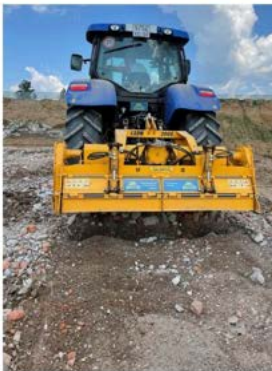
Рис. 10 – процесс изготовления рекультиванта минерального «РМ-Техно» первым способом с использованием роторатора.
